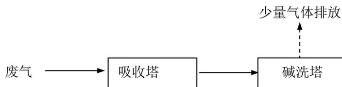
图 10-2-1 工艺废气处理工艺流程图
